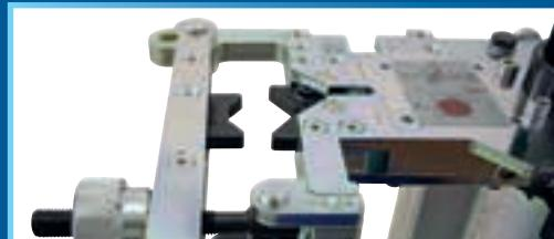
**Präzises Einstellen zum optimalen Fixieren und Spannen des Federbeins**
