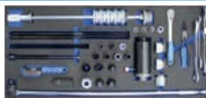
Das MODULO -System basiert auf einem 17 t Hydraulik-Zylinder. Alle Reparaturen können am Fahrzeug durchgeführt werden. Das spart Arbeit und zusätzlichen Aufwand, wie eine Achsvermessung.
