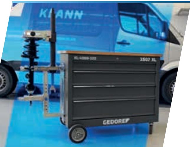
Universell einsetzbar an Fahrwerkssystemen bei PKW und Transportern. Mobiler Arbeitsplatz mit umfangreichem Spezialwerkzeug-Sortiment für schnelle, effiziente Instandsetzungsarbeiten, speziell im Bereich Feder- und Stoßdämpferwechsel.
