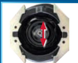
**Zum Zerlegen und Montieren von McPherson-Federbeinen.**
