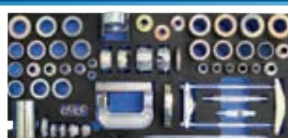
Ausbau von Lagern, Buchsen und Kugelgelenken direkt am Fahrzeug.
