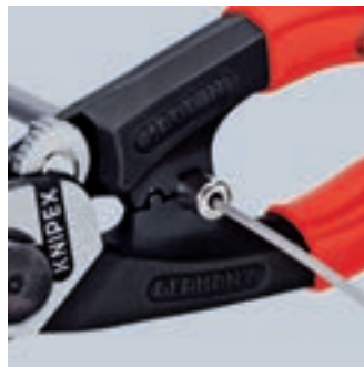
Anpressen der Endhülse an die Bowdenhülle
