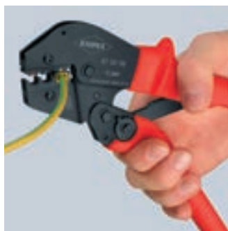
Zweiter Schritt: Jetzt die ganze Hand für den weiteren Crimpvorgang benutzen
