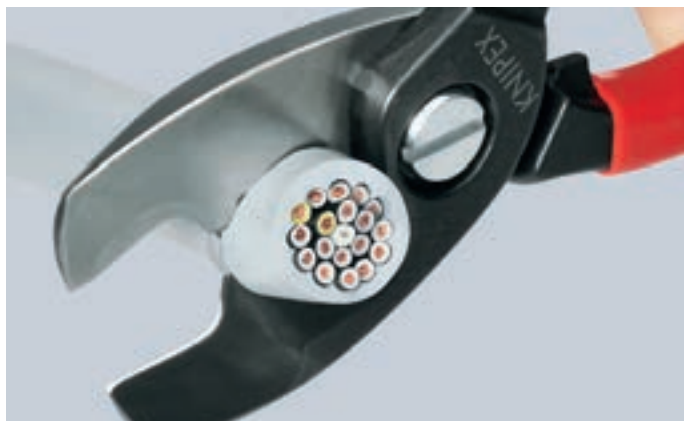
Nachschnitt: Nachdem der Mantel des Kabels im vorderen Profil durchgeschnitten wurde, werden die Leiter im hinteren Profil durchtrennt. Vorschnitt vorn, Nachschnitt hinten – so schneidet es sich leichter.
