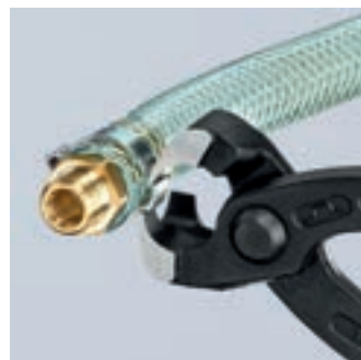
Abdichten Pneumatikschlauch an Schnellkupplung
