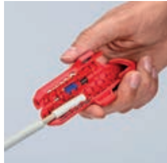
Abmanteln eines NYM-Kabels
