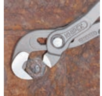
Arbeiten an verrosteter Mutter mit verrundeten Kanten
