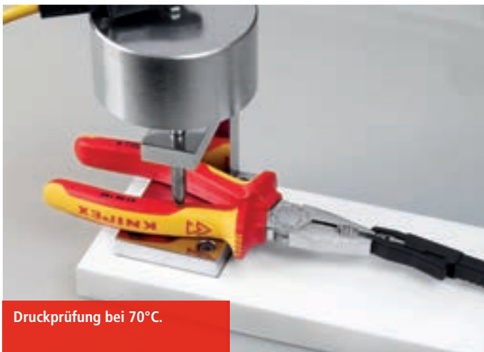
Prüfung der Haftfähigkeit der VDE-Hüllen mit 500 N.
