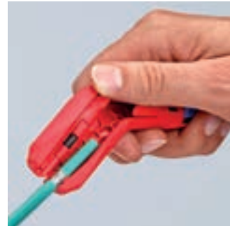
Abmanteln eines Datenkabels
