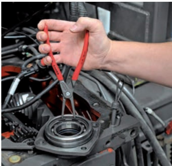
Stabile, eingesetzte Spitzen aus hochverdichtetem Federstahl
