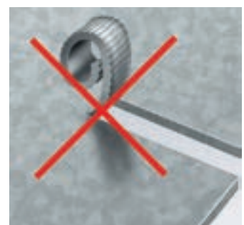
Ausklinken ohne Spanbrecher
