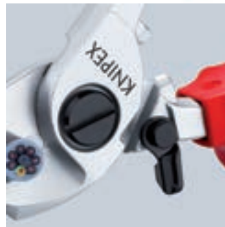
95 26 165: Sperrklinke verriegelt Scheren mit innenliegender Öffnungsfeder
