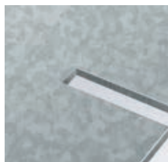
Ausklinken und Spanbrechen in einem Arbeitsgang
