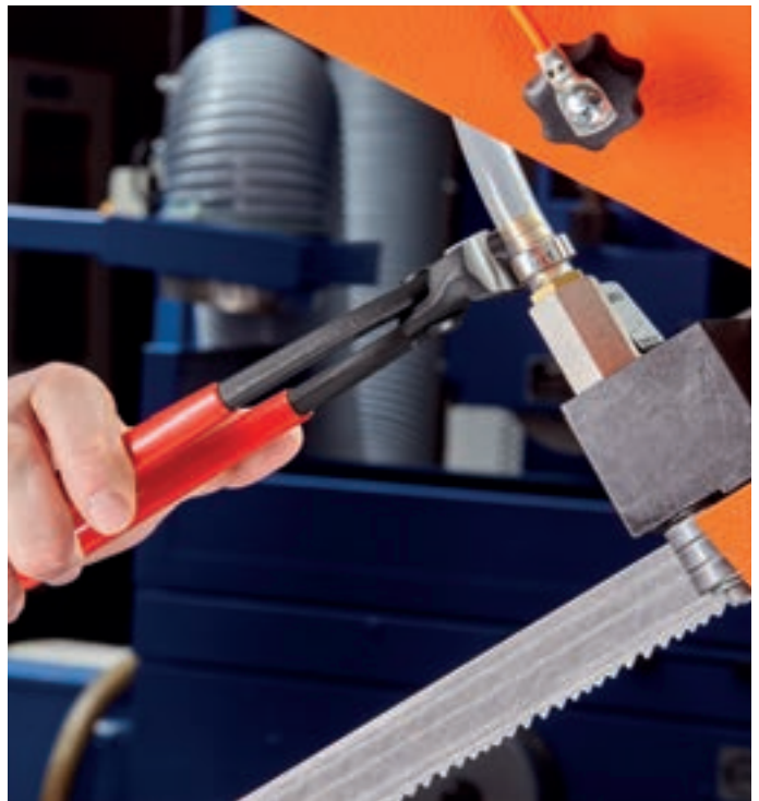
Abdichten Fluidschlauch an Stutzen mittels Seiten-Pressnase
