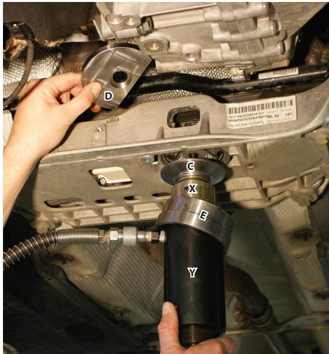
📸 13: Doppelsilentlager im 2. Schritt vollständig einpressen.
