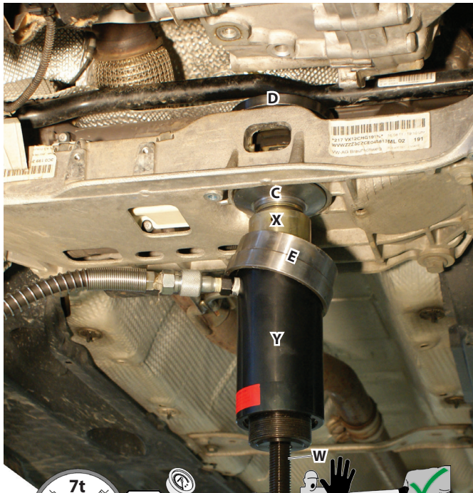
📸 13: Doppelsilentlager im 2. Schritt vollständig einpressen.
