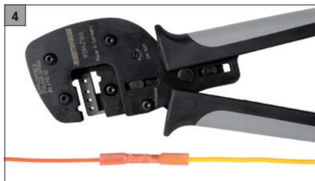
Les câbles doivent ensuite être sertis l'un après l'autre avec le connecteur. Dans cet exemple, notre pince de sertissage CrimPro30 est utilisée alternativement à la CrimPro10.
