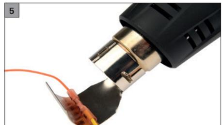
Abschließend erfolgt die Schrumpfung des Verbinders mithilfe eines Heißluftföns.
